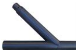
Trójnik segmentowy kątowy redukcyjny 45° i 60° PE 100 SDR 17 Wykonanie wg PN-EN 12201-3:2012
