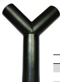
Trójnik segmentowy równoprzelotowy Y PE 100 SDR 11 Wykonanie wg PN-EN 12201-3
