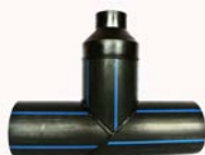
Trójnik segmentowy 90° redukcyjny PE 100 SDR 11
